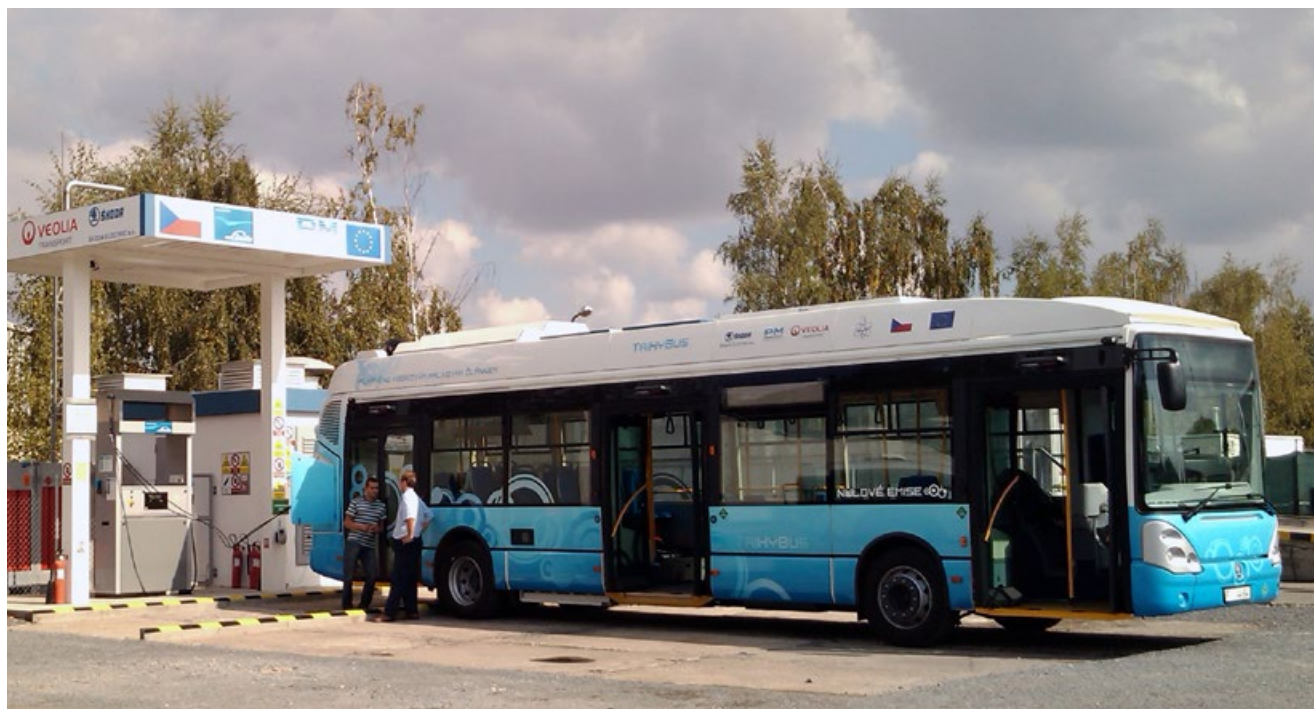
Prototyp vodíkového autobusu TriHyBus, který vyvinuli odborníci z Ústavu jaderného výzkumu v Řeži. Od roku 2009 jezdil pět let v Neratovicích. Foto: ÚJV Řež
