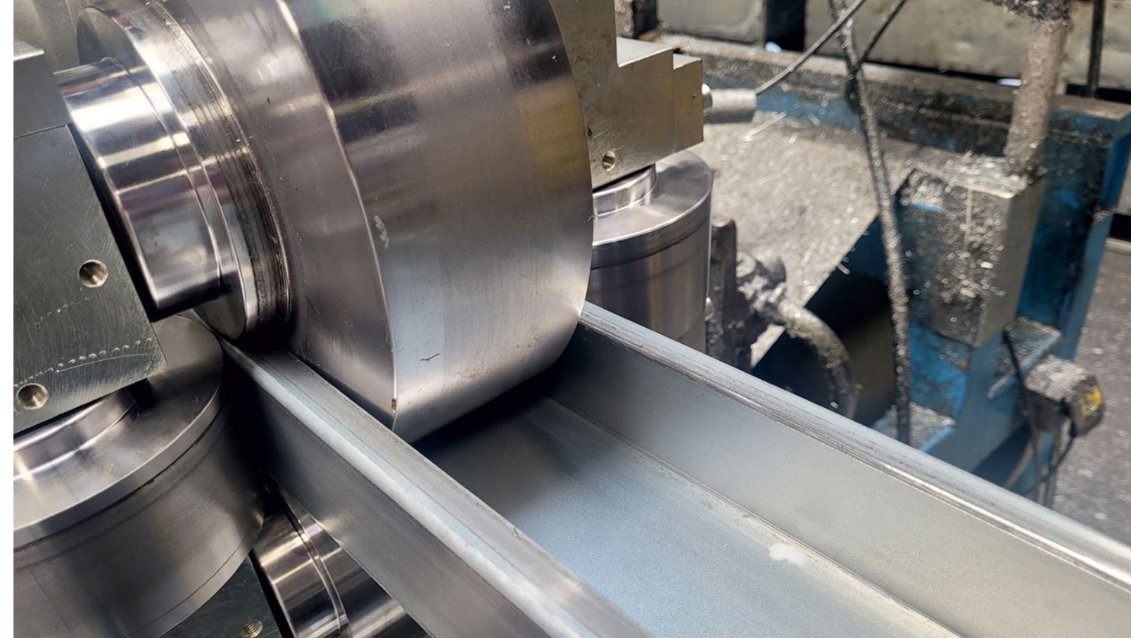
Výroba profilů probíhá za studena na dvanácti až čtyřicetistaticích. Zdroj: Bragen
